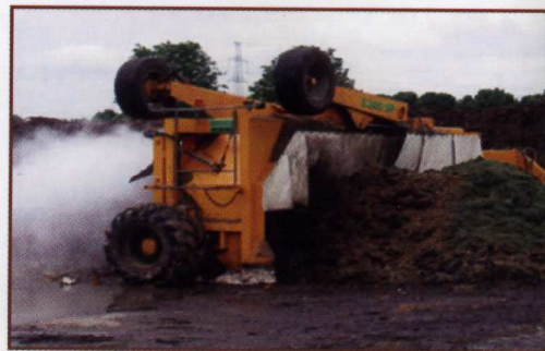
Passage d'un mélange de matière dans la co-composteuse
